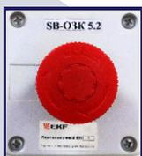
Кнопка предназначена для проверки работоспособности огнезадерживающего клапана. Нажав на кнопку клапан закроется, нажав повторно клапан вернётся в исходное состояние. Нажатие не приводит к включению каких-либо иных систем.
